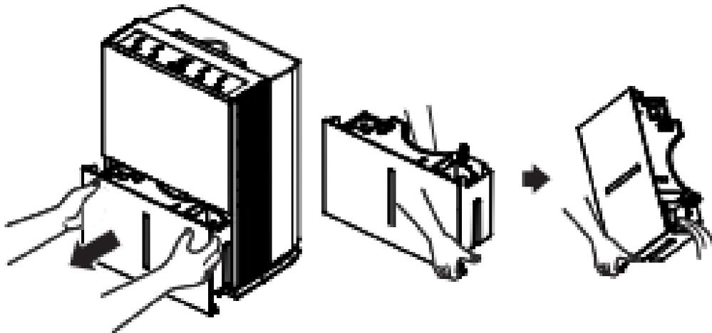
**ACHTUNG:** Entfernen Sie den Tank nicht, wenn der Luftentfeuchter in Betrieb ist oder wenn er gerade gestoppt hat, da dann immer noch etwas Wasser in den Tank laufen könnte. Wenn sich der Tank nicht im Gerät befindet, kann Ihnen dieses Wasser dann auf Ihren Boden auslaufen.
