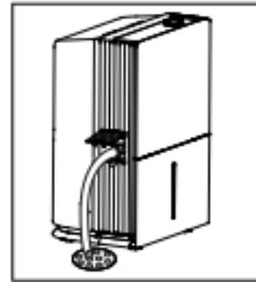
**ACHTUNG:** Sorgen Sie hierbei dafür, dass der Schlauch nicht geknickt wird und über die gesamte Länge abschüssig verläuft. Nun kann die Dauerdrainage durchgeführt werden.
