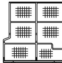
Öffnen Sie die Frontblende von vorne und ziehen Sie den Luftfilter vorsichtig nach unten aus dem Gehäuse.
